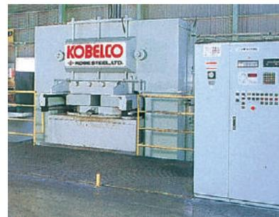
厳選された黒鉛を主原料とし、副原料とともに調合され、加熱混練、加圧成型、焼成工程を経て、綿密な検査を受けて出荷されます。
